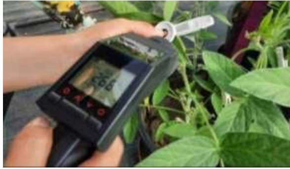
Slika 13. Senzor Dual Focus Infrared Thermometer (fotografija: Spišić, M., 2022.)
