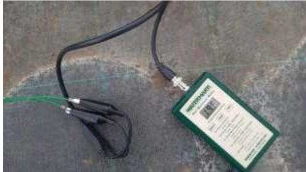
Slika 1. Watermark senzor (fotografija: Spišić, M., 2022.)
