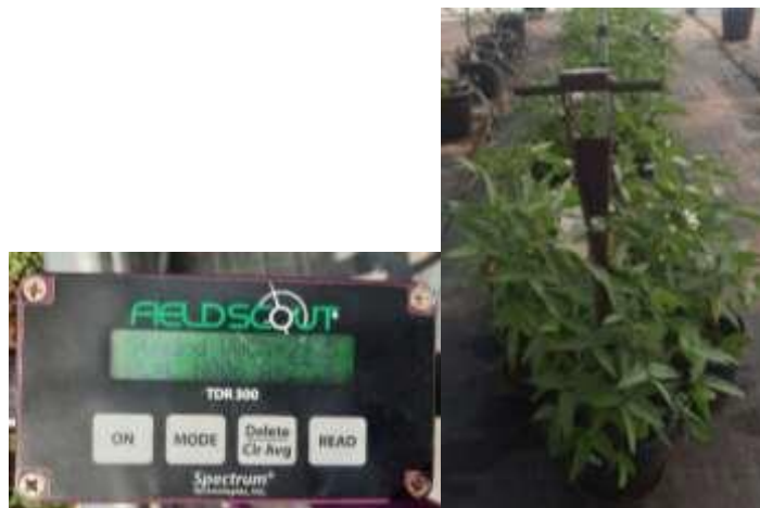
Slika 4. i 5. Time Domain Reflectometry (TDR) (fotografija: Spišić, M., 2022.)
