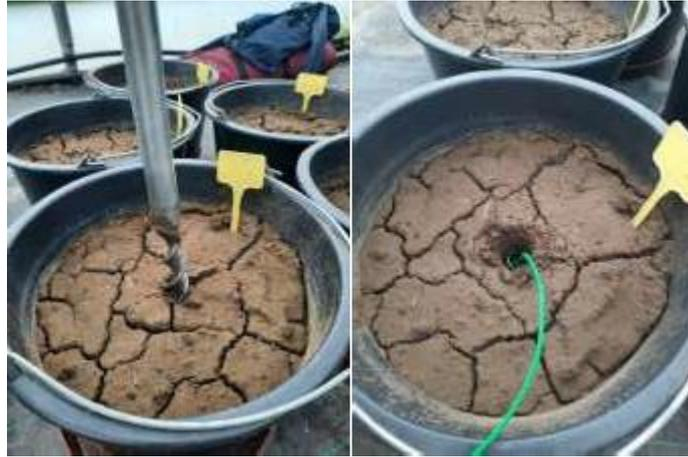
Slika 8. i 9. Postavljanje Watermark senzora (fotografija: Spišić, M., 2022.)
