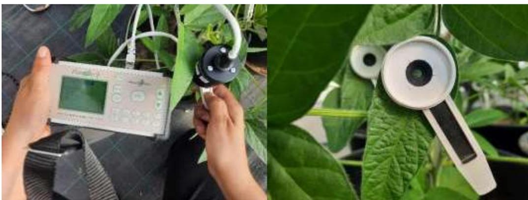
Slika 11. i 12. Senzor Handy Plant Efficiency Analyser (fotografija: Spišić, M., 2022.)
