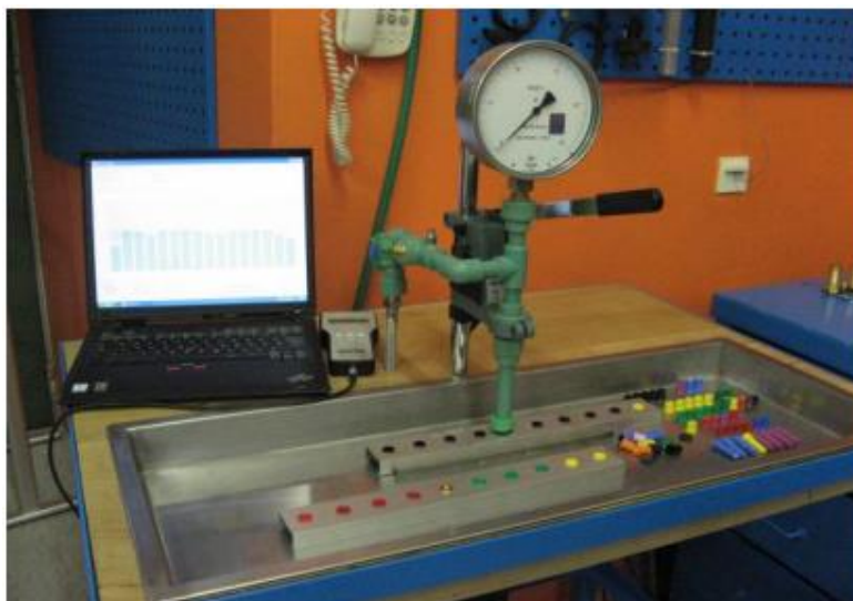
Slika 7: Stolno-elektronski uređaj za ispitivanje mlaznica
