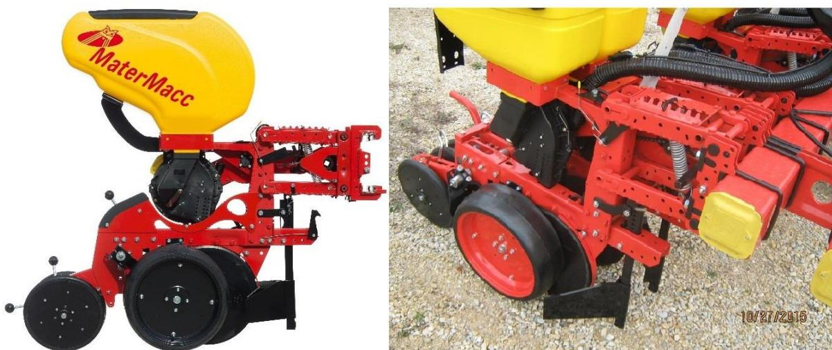
Slika 8. Sjetvena sekcija sijačice *MaterMacc Twin Row-2*
