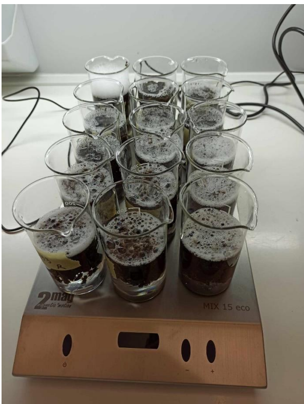
Slika 19. Miješanje uzoraka na magnetnoj mješalici
