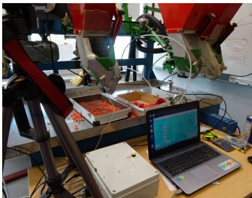
Slika 14. Programski sustav za kontrolu tehničkih čimbenika sjetve (Izvor: Beljo, 2022.)
