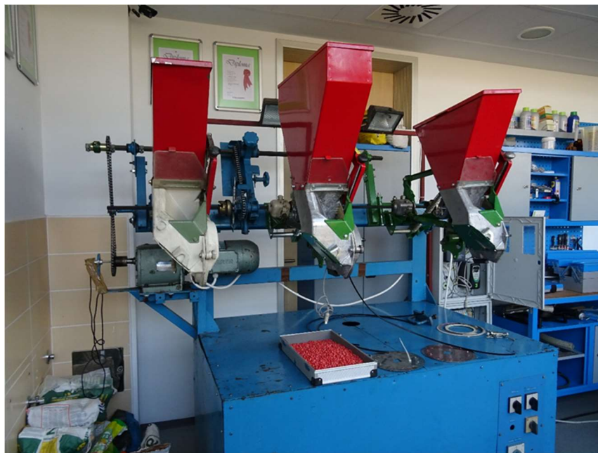
Slika 12. Sjetvene sekcije PSK OLT sijačice na ispitnom stolu u Centralnom laboratoriju za poljoprivrednu tehniku i obnovljive izvore energije
