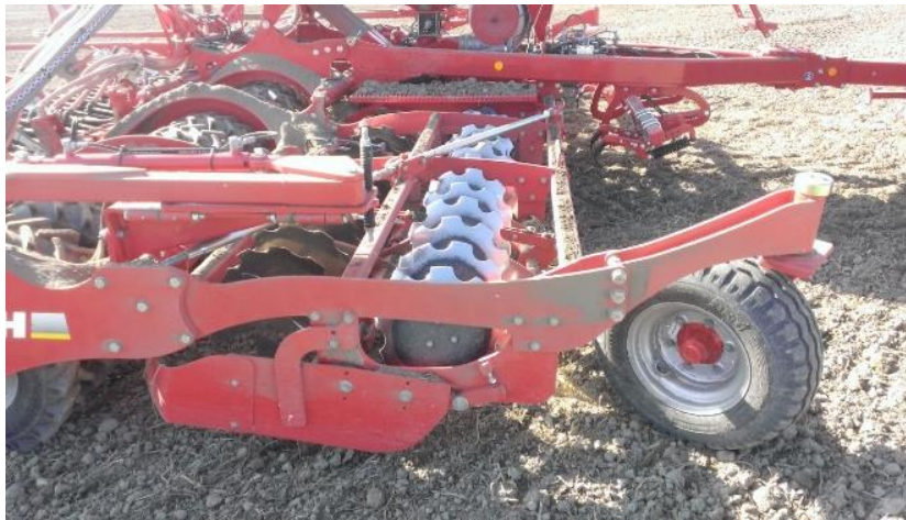
Slika 24. Sistem diskova koji obavljaju usitnjavanje
