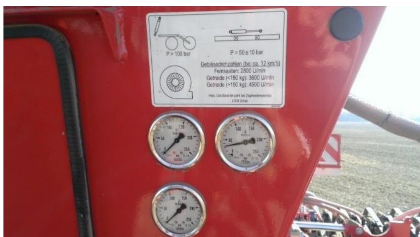
Slika 21. Instrumenti za očitavanje veličina rada ventilator
