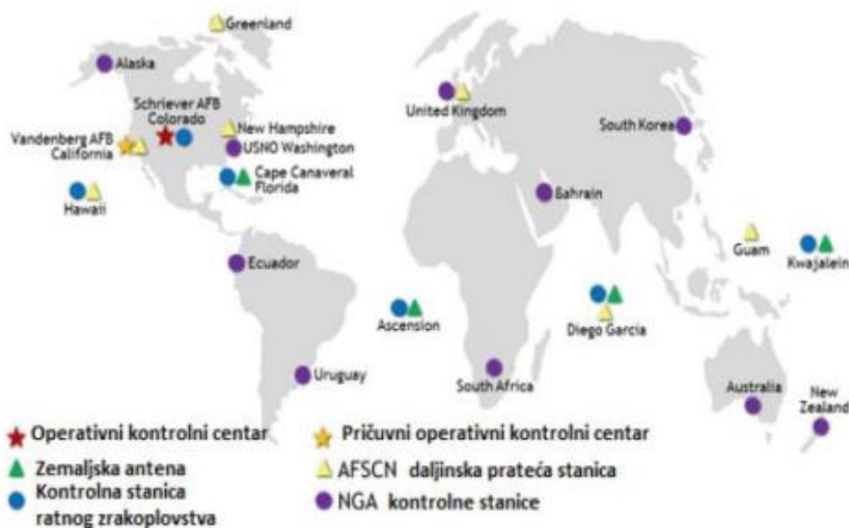
Slika 5. Kontrolni segmenti GPS sustava raspoređeni na Zemlji
