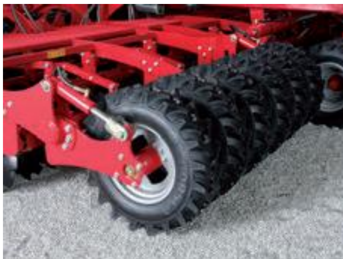
Slika 25. Packer valjak s pneumaticima
