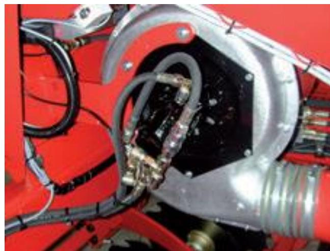
Slika 20. Motor ventilator
