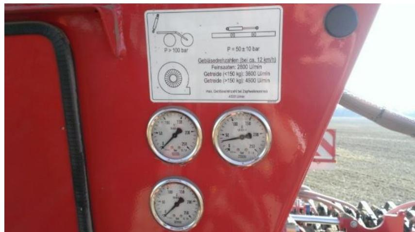
Slika 21. Instrumenti za očitavanje veličina rada ventilator
