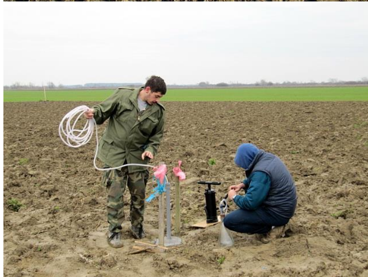
Slika 3. Postavljanje piezometra i uzimanje uzoraka vode iz piezometra
