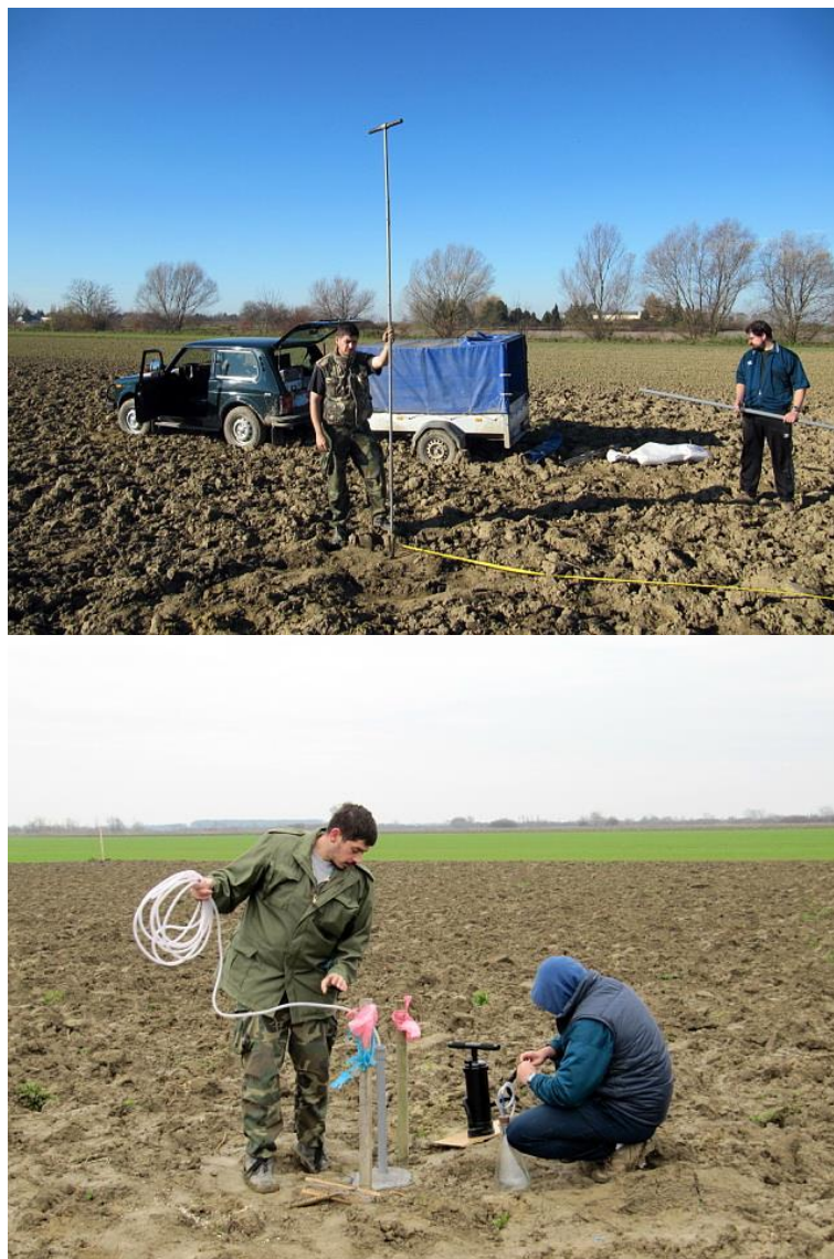
Slika 3. Postavljanje piezometra i uzimanje uzoraka vode iz piezometra
