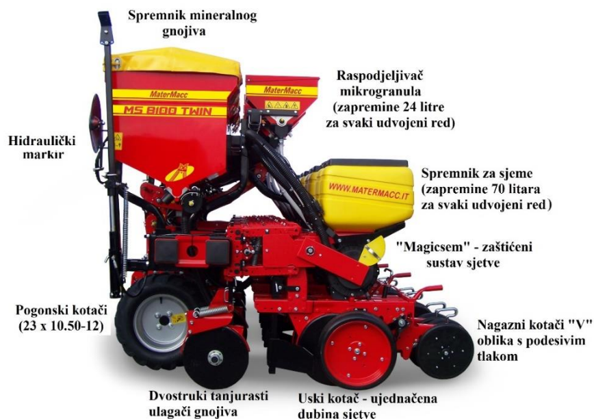
Slika 6. Glavni sustavi sijačice MaterMacc Twin row – 2
