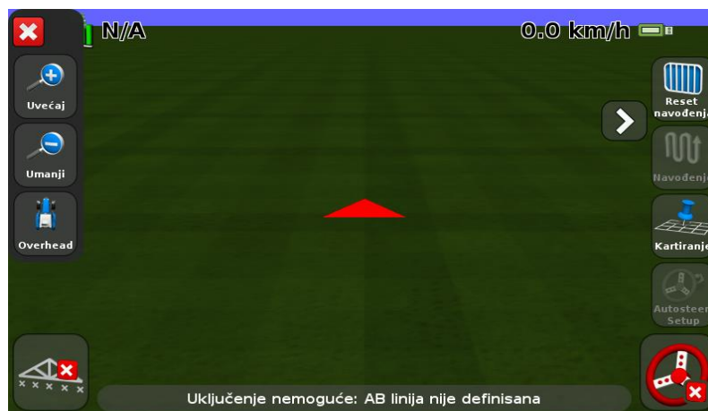
Slika 34. Ikonice za promjenu perspektive (Trimble CFX – 750 priručnik za korisnike)
