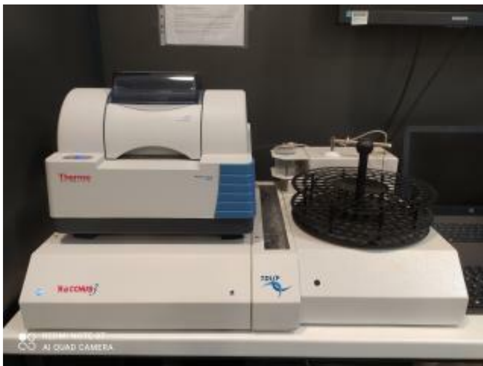
Slika 5. Uređaj Bacchus za fizikalno-kemijsku analizu vina
