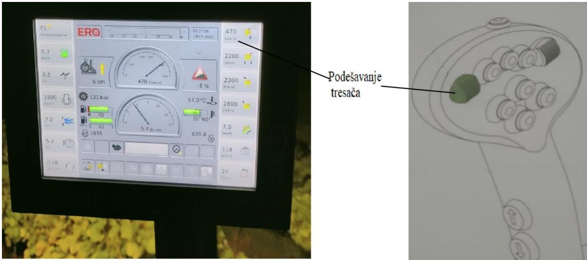
Slika 19. Podešavanje tresača na joysticku i lcd ekranu
