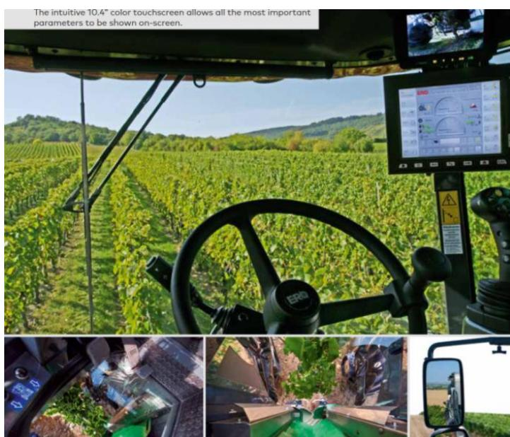
Slika 10. Elektromagnetna ticala i navođenje iz kabine stroja
