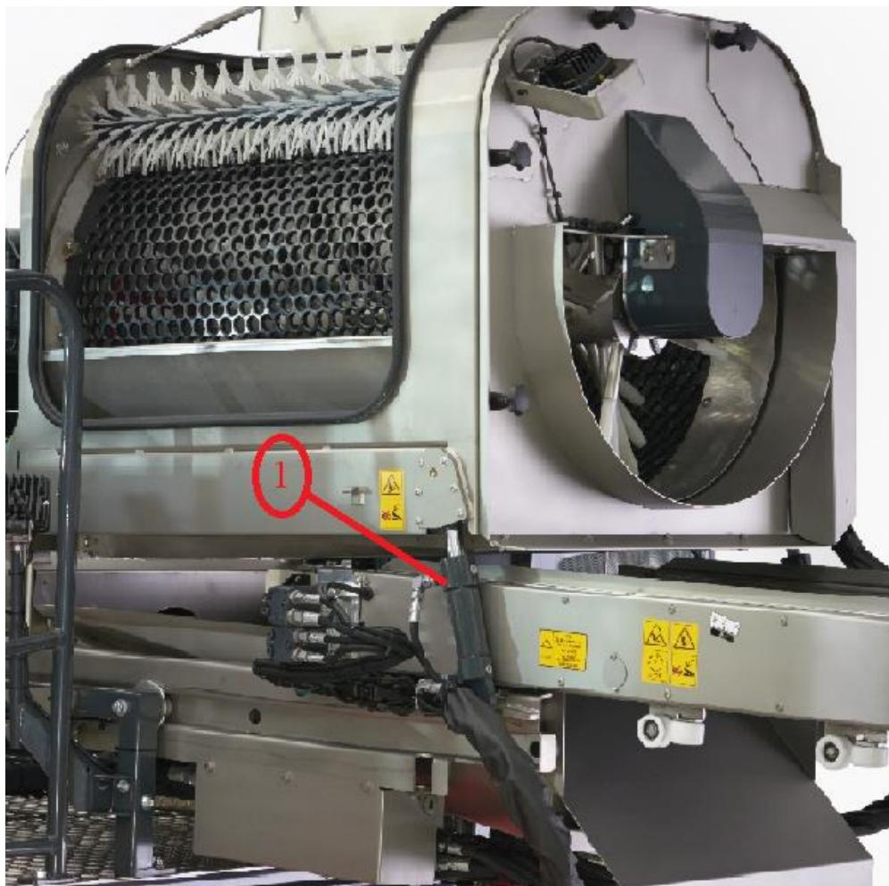
Slika 30. Cilindri (1) koji održavaju nagib ruljače
