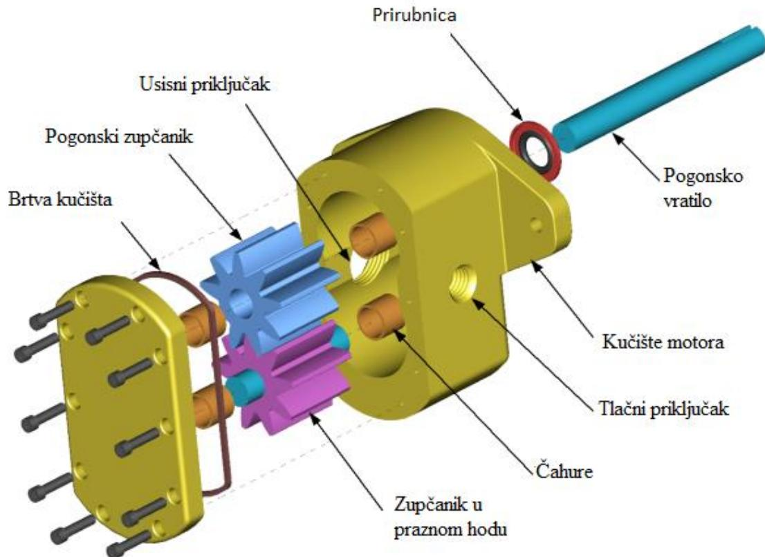
Slika 9. Hidraulični motor
