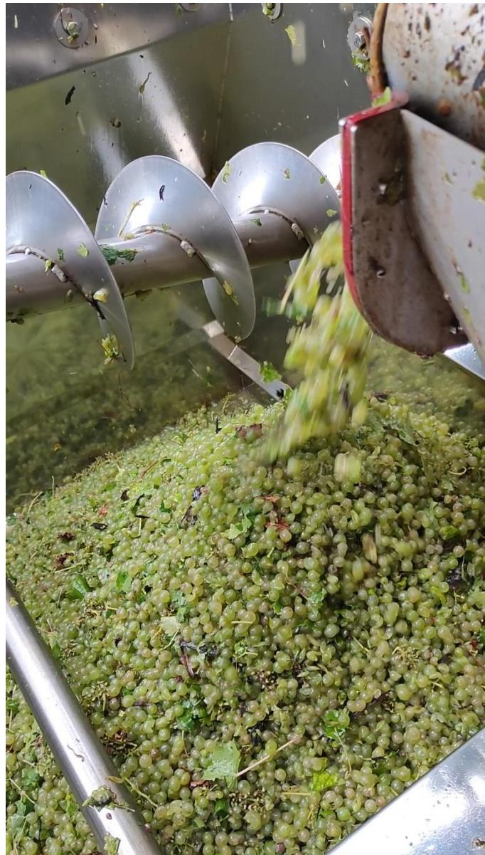
Slika 31. Transport iz ruljače u spremnik kombajna
