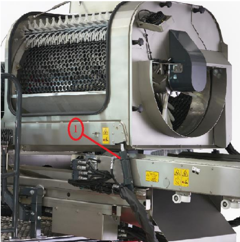
Slika 30. Cilindri (1) koji održavaju nagib ruljače
