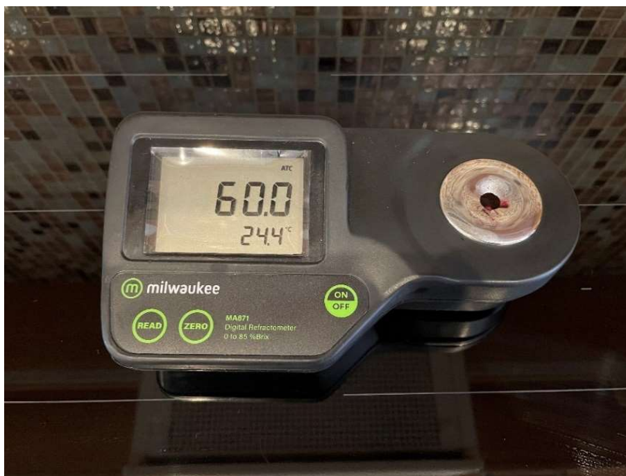
Slika 2. Mjerenje količine šećera refraktometrom (vlastiti izvor)
