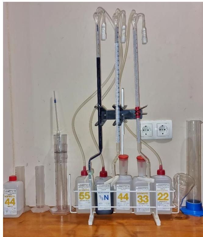
Slika 11: Titrofix – uređaj prema Dr. Rebeleinu za brzu titraciju, za određivanje ukupnog SO<sub>2</sub>, slobodnog SO<sub>2</sub> i ukupne kiseline, erlenmayer tirkvica 250 ml, pipeta 25 ml, menzure
