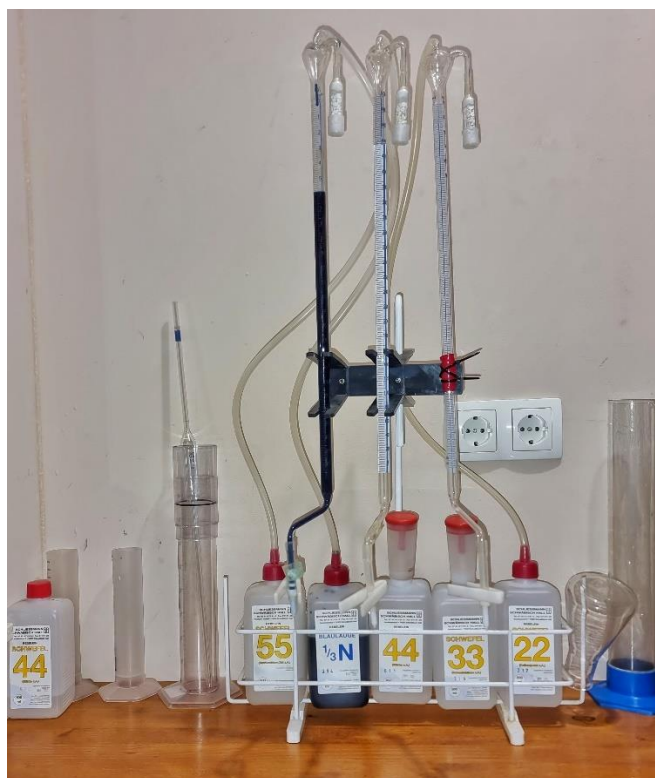
Slika 11: Titrofix – uređaj prema Dr. Rebeleinu za brzu titraciju, za određivanje ukupnog SO 2 , slobodnog SO 2 i ukupne kiseline, erlenmayer tikvica 250 ml, pipeta 25 ml, menzure (Izvor: vlastiti izvor)
