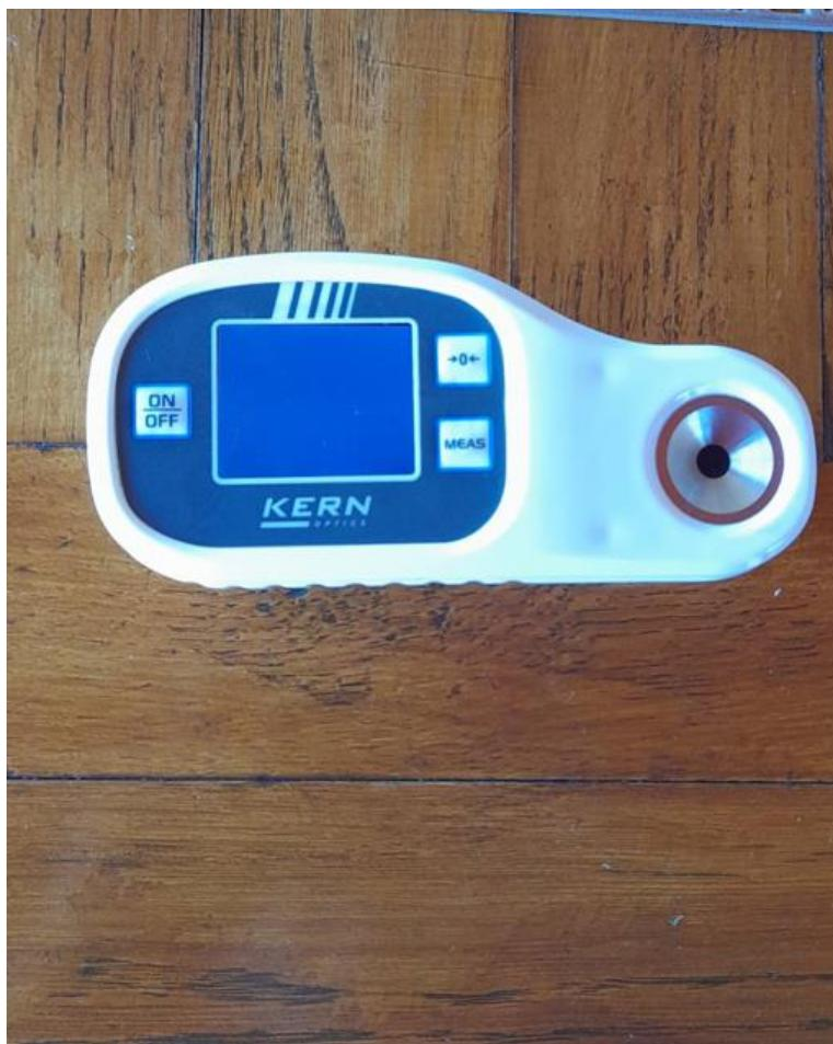
Slika 5. Digitalni refraktometar Kern ORF 2WM (Izvor: M. Drenjančević, 2020.)
