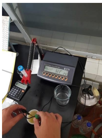
Slika 9. Postupak određivanja pH-vrijednosti Izvor: Autor
