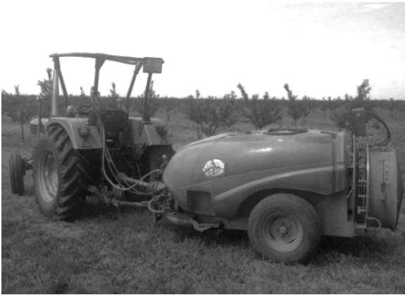
Slika 2. Vučeni raspršivač Tifone Vento 1500 i sustav senzora Sick .
