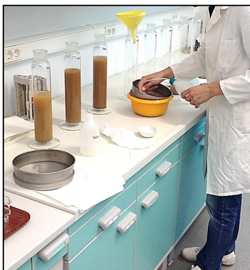
Slika 7. Određivanje frakcije pijeska
