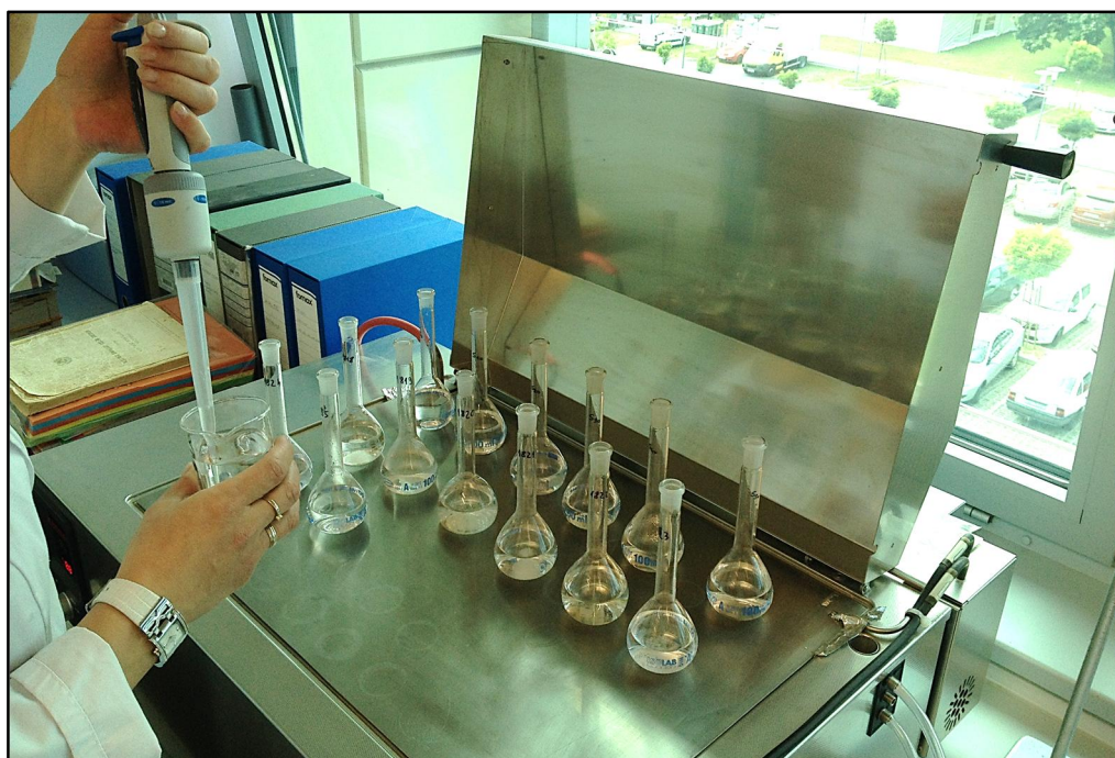
Slika 12. Priprema uzoraka za određivanje fosfora (dodavanje 1,44 %-tnog amonijevog molibdata i 2,5 %-tne askorbinske kiseline)
