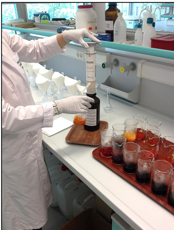
Slika 14. Dodavanje sulfatne kiseline u uzorke tla
