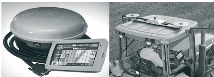
Slika 5. GPS antena s dodirnim zaslonom (lijevo), GPS antena ugrađena na krov traktora (desno) (izvor: Rajković, 2013. )
