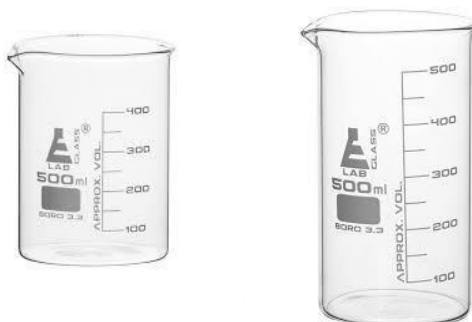
Slika 3. Niski i visoki tip laboratorijske čaše.
