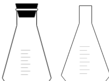
Slika 8. Erlenmeyerova tikvica s ubrušenim grlom s čepom i uskim grlom bez čepa.
