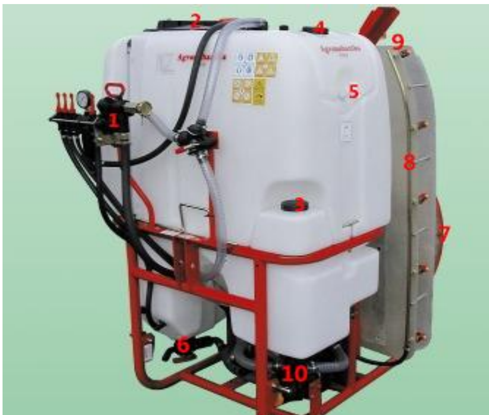
Slika 5. Glavni dijelovi raspršivača AGP 200 EN
