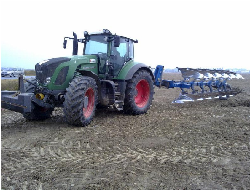
Slika 3. Traktor FENDT i plug LEMKEN (polunošeni) ( http://img230.imageshack.us/img230/8595/07092010119.jpg )
