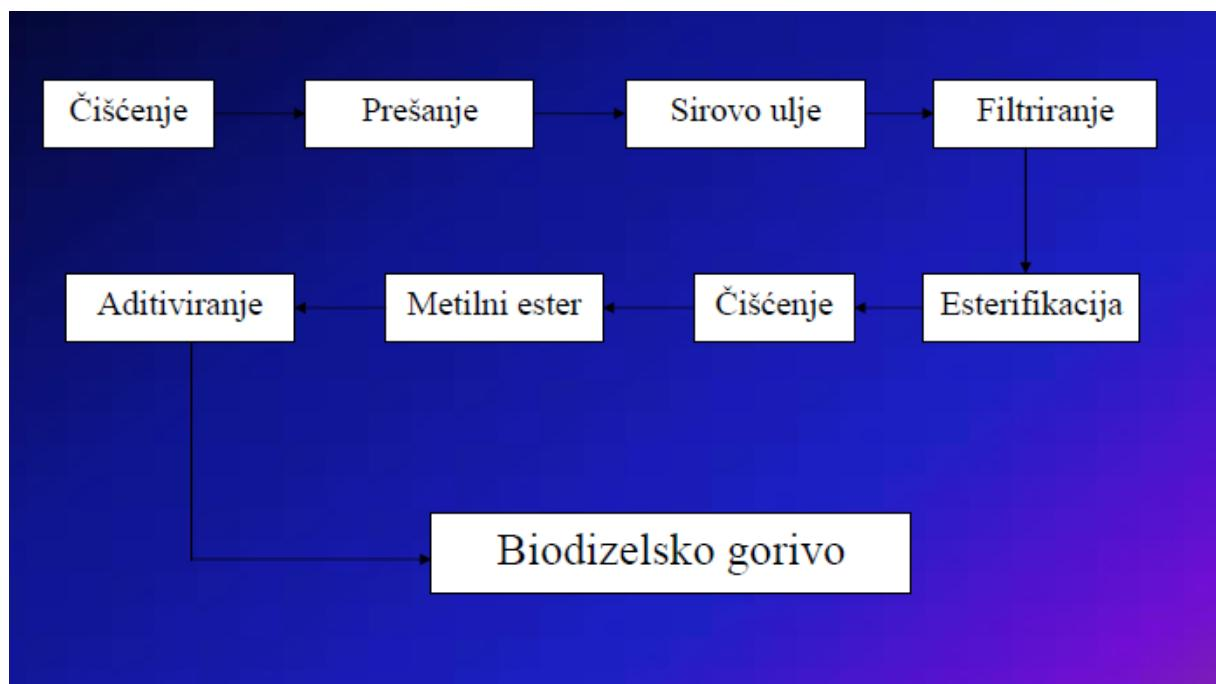
Slika 7: Redoslijed procesa proizvodnje biodizela od ulja uljarica
