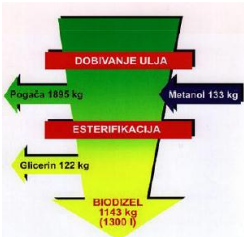
Slika 8: Shematski prikaz dobivanja biodizelskog goriva od uljane repice
