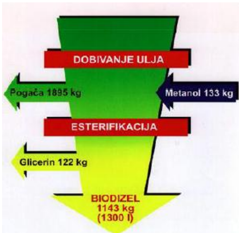
Slika 8: Shematski prikaz dobivanja biodizelskog goriva od uljane repice
