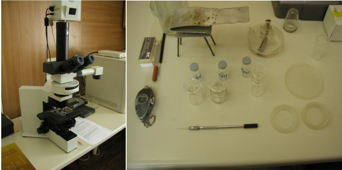
Slika 9. i 10. Mikroskop pomoću kojeg se vrše pregledi i determinacija nematoda te laboratorijski pribor koji služi za analiziranje nematoda
