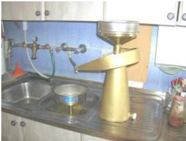
Slika 1. Fenwickov aparat za izdvajanje cistolikih nematoda (Foto: Magdika, 2004.)
