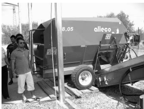
Slika 3. Stroj za miješanje kompostnog materijala (foto: M. Stojnović)
