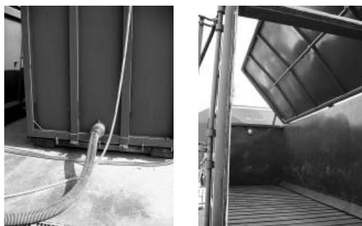
Slika 5. Spoj cijevi za aeraciju i unutrašnjost kontejnera (foto: M. Stojnović)
