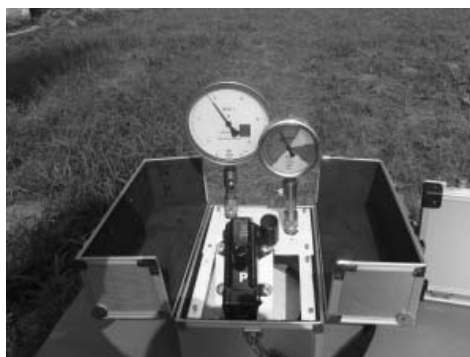
Slika 2. Komparator tlaka Volos
