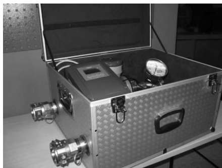
Slika 1. Elektromagnetni mjerač kapaciteta crpke tvrtke Krohne
