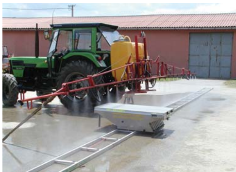
Slika 4. Ispitivanje površinske raspodjele tekućine kod nošene ratarske prskalice
