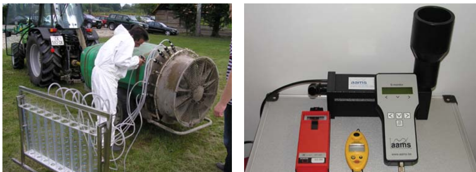
Slika 3. Uređaji za mjerenje protoka mlaznica
