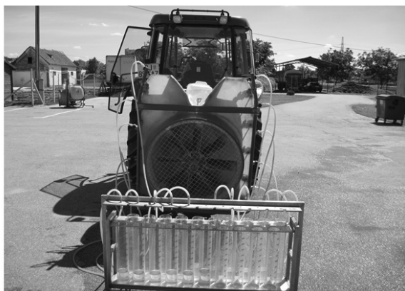
Slika 3. Menzure za mjerenje protoka mlaznica raspršivača
