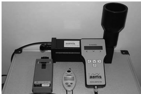
Slika 4. Elektronski mjerač protoka mlaznica belgijske tvrtke AAMS
