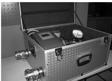
Slika 1. Elektromagnetni mjerjač kapaciteta crpke tvrtke Krohne
