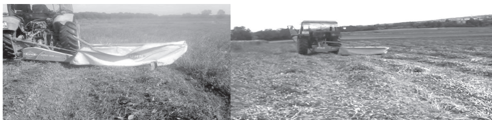
Slika 1: Košnja diskosnom i bubnjastom kosilicom (Foto: Crnković)
