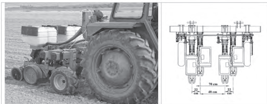
Slika 1. Sijačica MaterMacc Twin Row-2 i razmak redova u sjetvi
