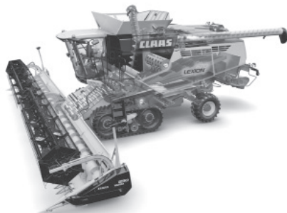
Slika 1 Prikaz tangencijalnog kombajna
