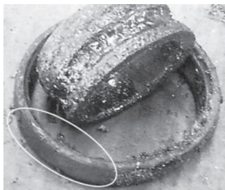
Slika 11. Tribokorozivno trošenje vanjskog prstena ležaja (Đurkić, 2018.)
