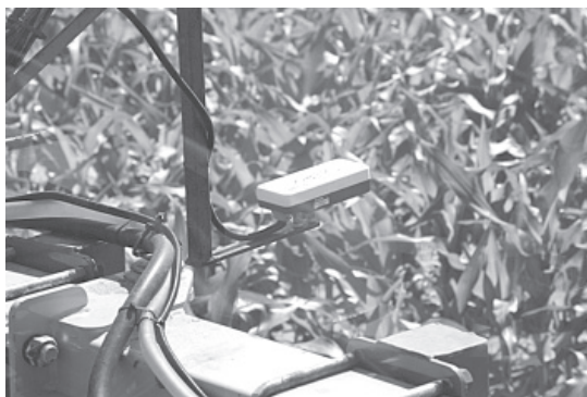
Slika 2. Senzor OptRx postavljen na traktor u radu (Ag Leader, 2019.)
