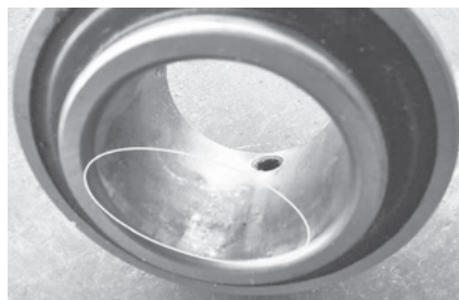
Slika 12. Tribokorozijsko trošenje unutarnjeg prstena ležaja (Đurkić, 2018.)
