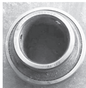
Slika 6. Očišćeni Y-ležaj (Đurkić, 2018.)
