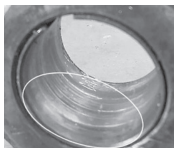
Slika 8. Abrazijsko trošenje unutarnjeg prstena ležaja (Đurkić, 2018.)(Đurkić, 2018.)
