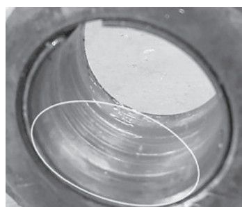
Slika 8. Abrazijsko trošenje unutarnjeg prstena ležaja (Đurkić, 2018.)(Đurkić, 2018.)
