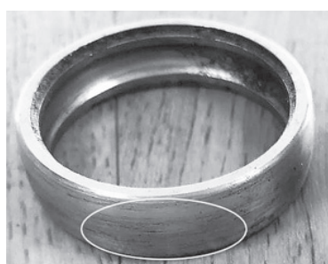
Slika 7. Abrazijsko trošenje vanjskog prstena ležaja (Đurkić, 2018)
