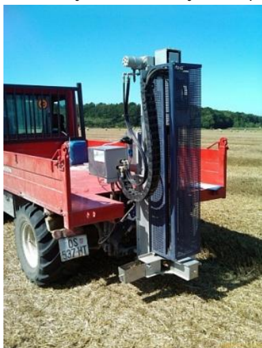
Slika 3. Hidraulična, automatska sonda za uzorkovanje tla
