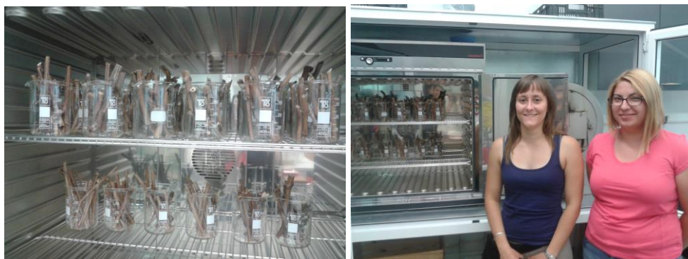
Slike 23. i 24. Priprema ostataka za sušenje u sušioniku
