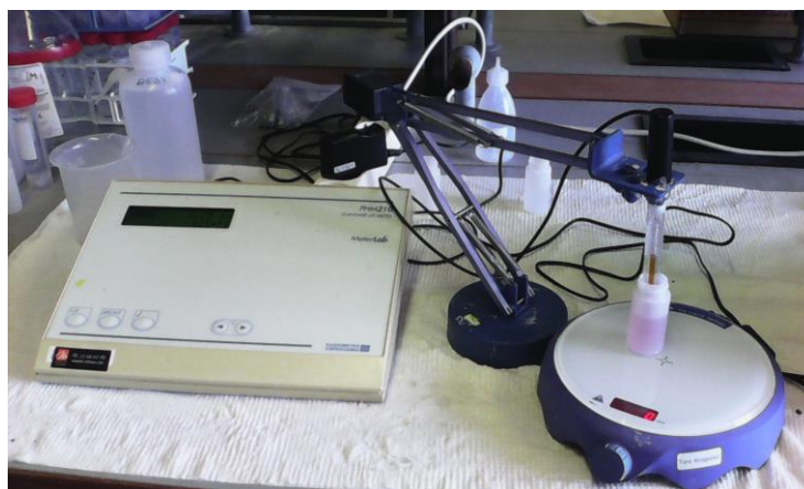
Slika 1. Mjerenje pH tla (Foto: Dejana Kraljević)
