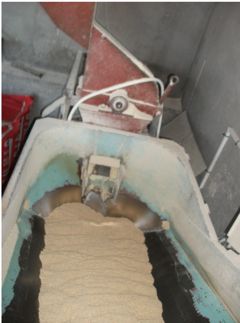
Slika 20. Prikaz mljevenja i miješanja hrane za junad na istraživanom OPG-u (Foto: I. Čunko)
