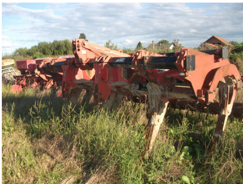
Slika 5. Oruđe za obradu tla : podrivač sa 7 radnih tijela na istraživanom OPG-u (Foto I.Čunko)
