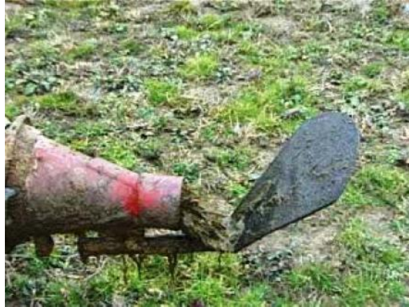
Slika 17. Lepezasti rasprskivač tijekom primjene gnojiva uzrokuje snažno širenje neugodnog mirisa (Katalinić i sur., 2009.)
