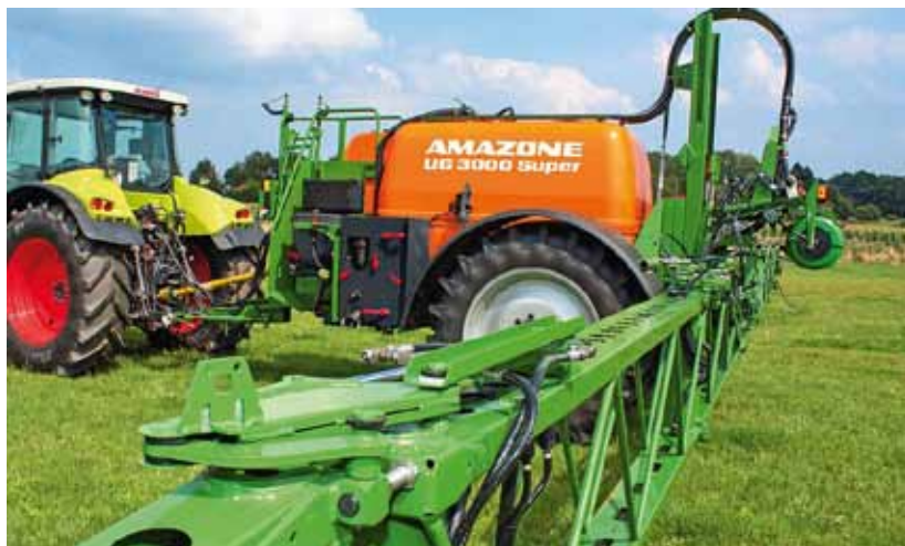
Slika 5. Amazone UG 3000 Super vučena prskalica (Izvor: amazone.net/en/products-digital-solutions/ )
