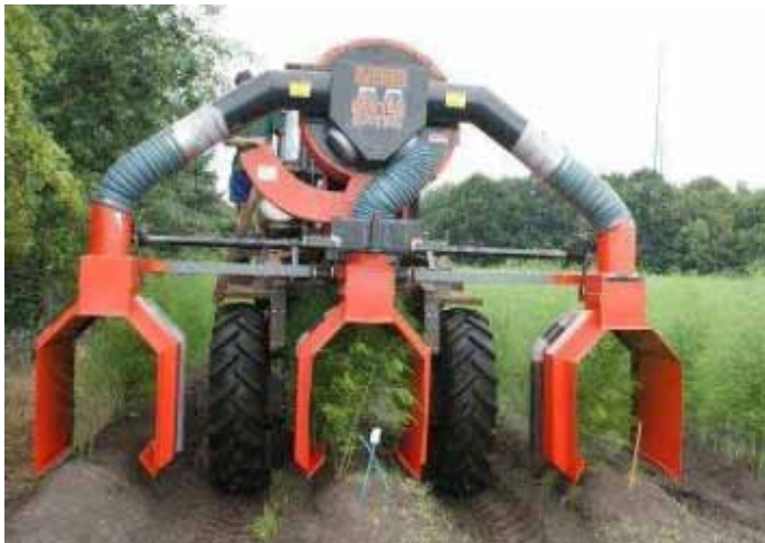
Slika 1. Pneumatski sustav prikupljanja štetnika (Izvor: www.plantenziektekunde.nl )
