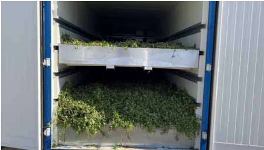
Slika 4. Unutrašnjost prijenosne kondenzacijske sušare
