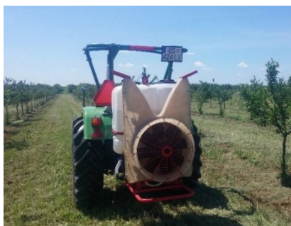
Slika 1. Raspršivač Agromehanika AGP 200 ENU Figure 1. Agromehanika AGP 200 ENU orchard sprayer
