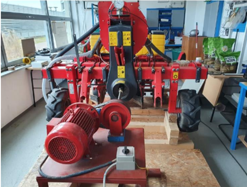
Slika 4. MaterMacc TwinRow sijačica na ispitnom stolu (Izvor: Kovačević, 2020.)
