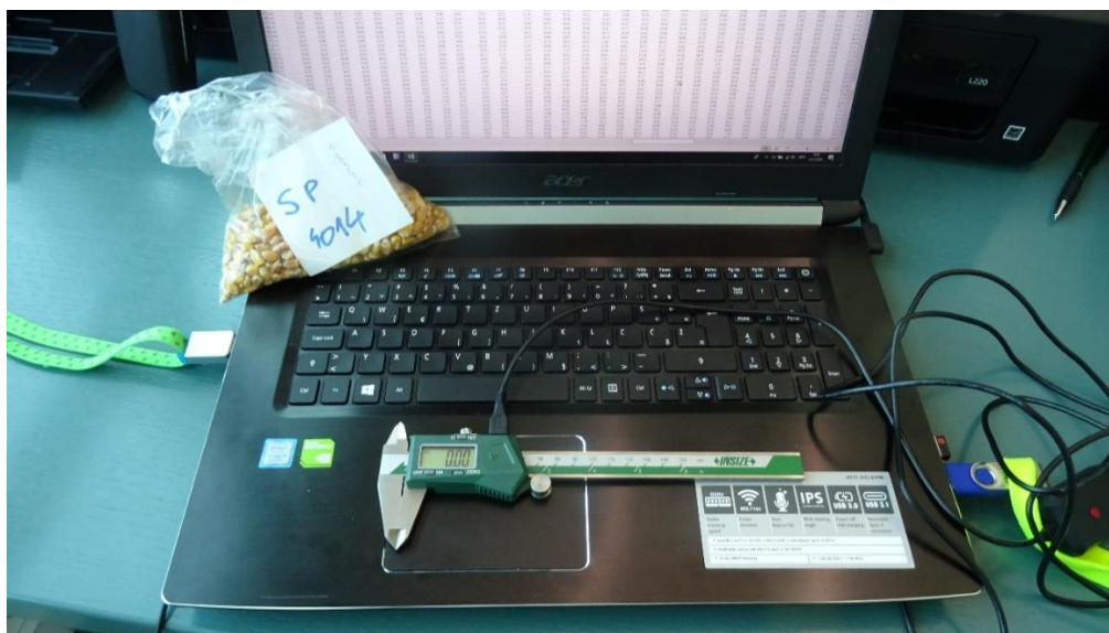
Slika 12. Pomično mjerilo za mjerenje oblika sjemena
