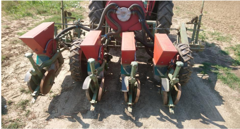
Slika 14. Pneumatska sijačica OLT PSK pripremljena za sjetvu uljane repice
