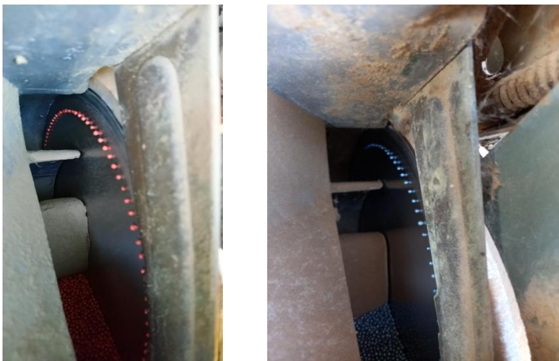
Slika 16. Položaj sjemena na sjetvenoj ploči; lijevo KWS sjeme, desno DKC sjeme
