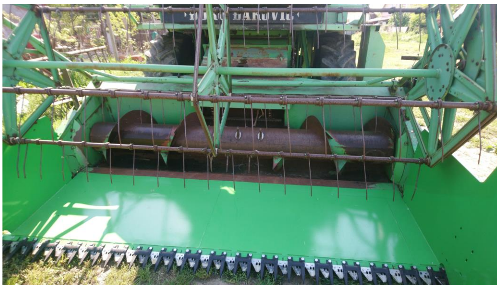
Slika 20. Žetveni uređaj kombajna za ubiranje uljane repice
