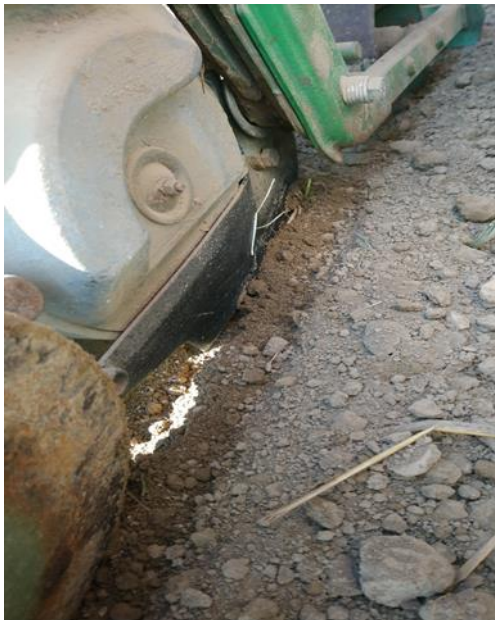
Slika 15. Oprema za sjetvu repe i povrća – kopirni kotač s odstranjivačem gruda i raončić
