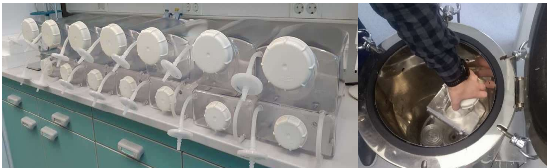
Slika 10. Bioreaktorske jedinice SETIS TM i autoklaviranje komora za rast (Puntarić, 2024.)
