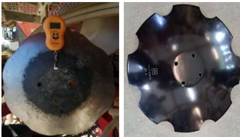
Slika 31. Usporedba istrošenog i novog diska
