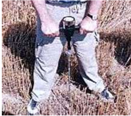
Slika 3. Postupak korištenja mehaničkog penetrometra
