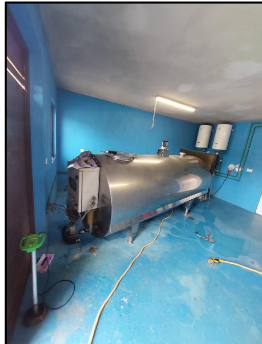
Slika 11. Laktofriz za skladištenje mlijeka kapaciteta 2700 L (Izvor: vlastita fotografija)
