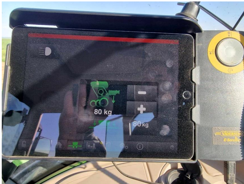
Slika 21: pritisak sjetvene jedinice na tlo (784,4 N/80 kg)
