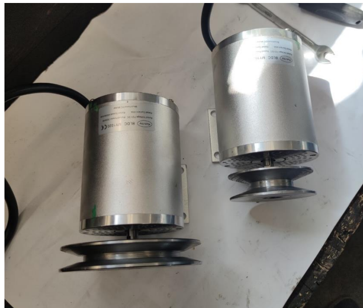
Slika 8. Elektromotori sa gotovim remenicama
