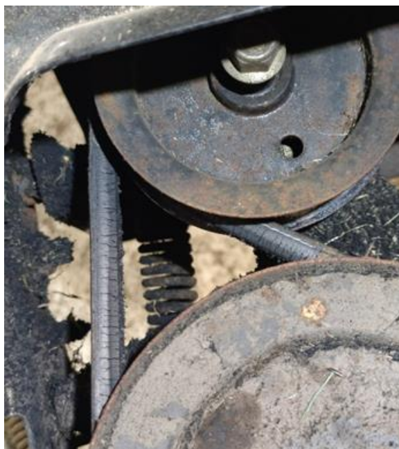
Slika 12. Prikaz iskorištenog remena
