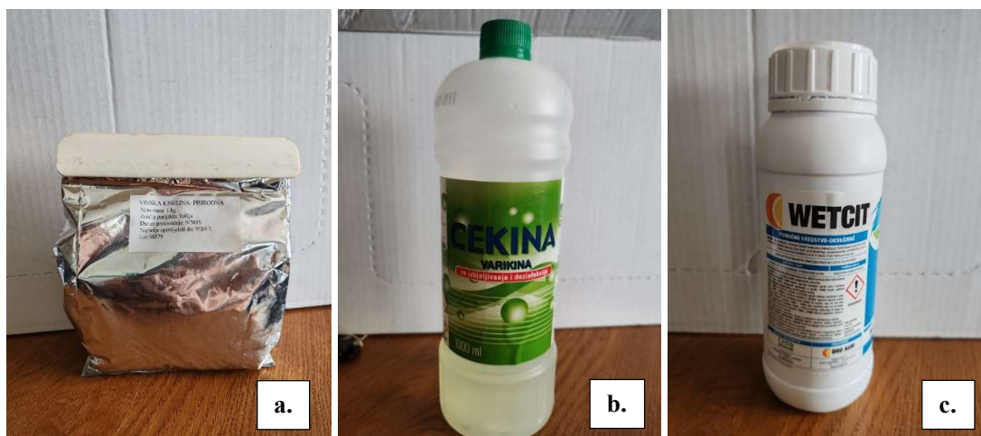
Slika 9. Korištena a. vinska kiselina, b. natrijev hipoklorit \text{NaOCl} i c. okvašivač (Gusak, 2024.)
